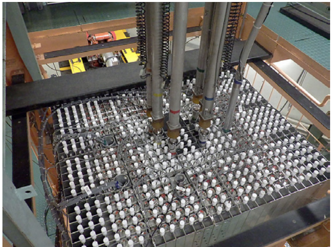
原子炉の上に立って説明する三澤副所長 原子炉と制御棒（中心の6本の棒が制御棒）
