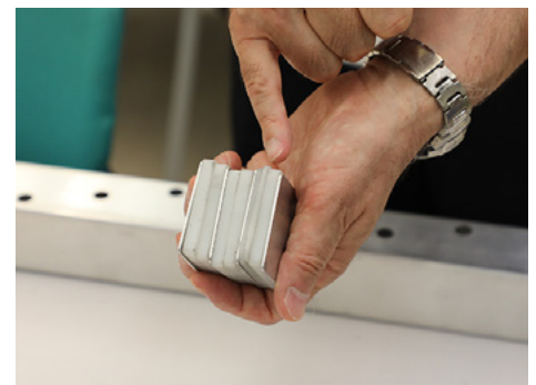
燃料集合体の模型。ポリエチレンと核燃料の組み合わせを容易に変えることができる
