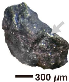
松本助教らは、リュウグウの砂を大気に全く触れない状態に注意深く保ち、その表面を光学顕微鏡や走査型電子顕微鏡<sup>1</sup>を使って観察しました。すると、砂の表面に小さな白い鉱脈が発達していることを見つけました(図 1, 2)。鉱脈を形成する鉱物を、ナノメートルに及ぶ小さな構造を観察できる透過型電子顕微鏡<sup>2</sup>を使って観察すると、ナトリウム炭酸塩( $\text{Na}_2\text{CO}_3$ )、岩塩( $\text{NaCl}$ : 塩化ナトリウム)の結晶や、ナトリウム硫酸塩( $\text{Na}_2\text{SO}_4$ )がその成分であることがわかりました(図 3)。鉱物種の正確な同定には愛知県岡崎市の極端紫外光研究施設 UVSOR で開発された走査型透過 X 線顕微鏡<sup>3</sup>を使用しました。また、リュウグウの砂の三次元的な構造や砂全体の鉱物を知るために、兵庫県佐用郡の大型放射光施設 SPring-8<sup>4</sup>(BL20XU)で開発された X 線トモグラフィ<sup>5</sup>を用いて砂の非破壊観察を行いました。
