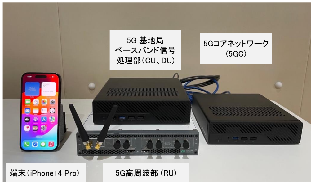
図1 開発したオープンソース型小型ローカル 5G システム
