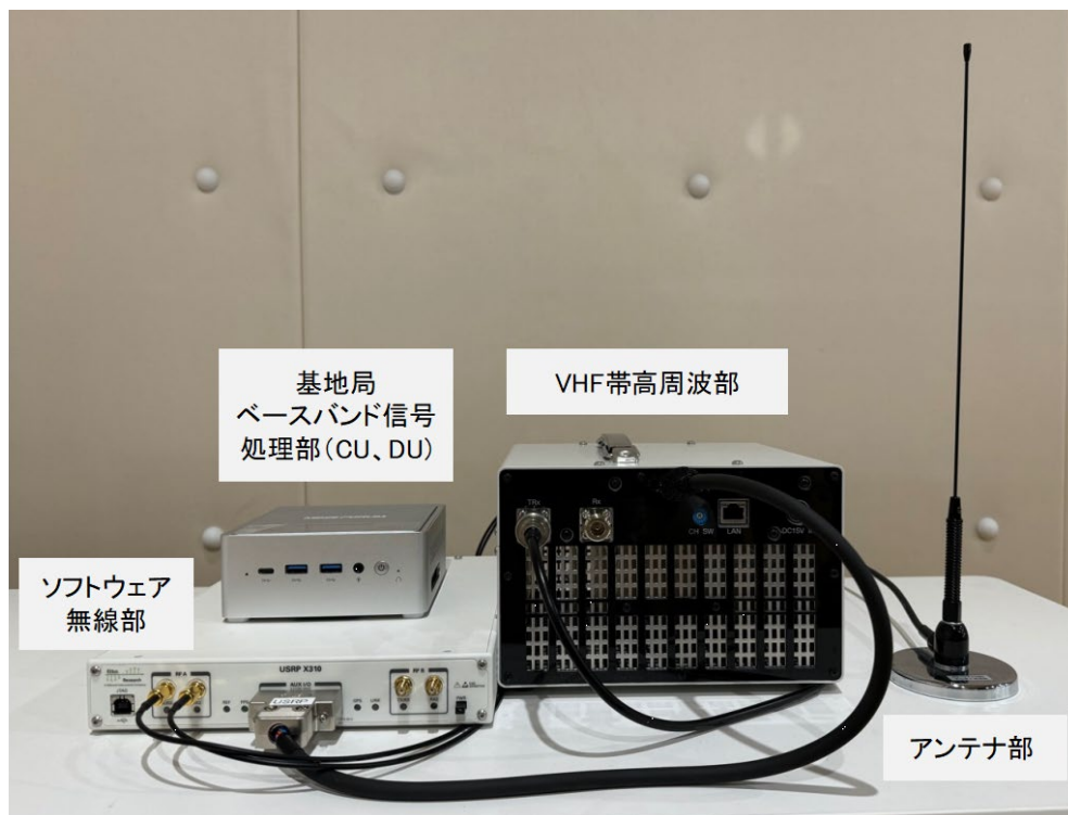
図1 開発した VHF 帯自営系（プライベート）5G システム（基地局） （端末も同じ構成（ベースバンド信号処理部に搭載するソフトウェアのみが異なる））
