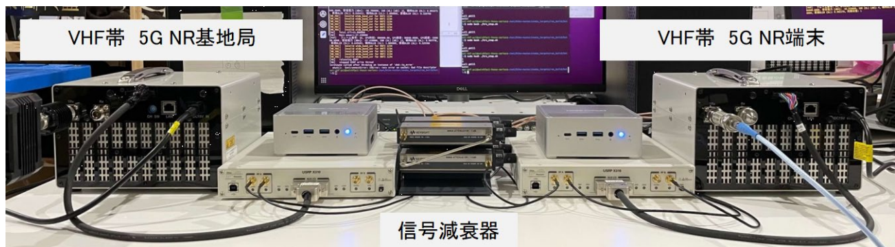
図2 開発した超広域小型自営系（プライベート）5G システムの評価系
