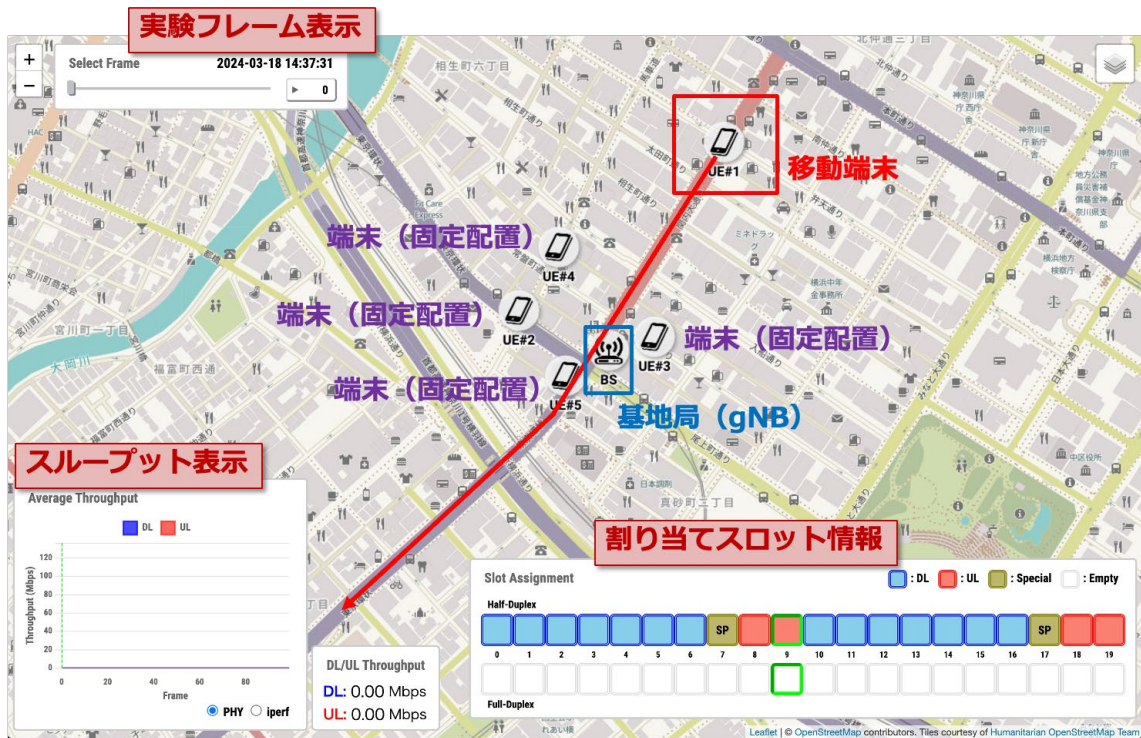
図 5：神奈川県横浜市みなとみらい地区における評価実証（基地局及び端末の配置状況）
