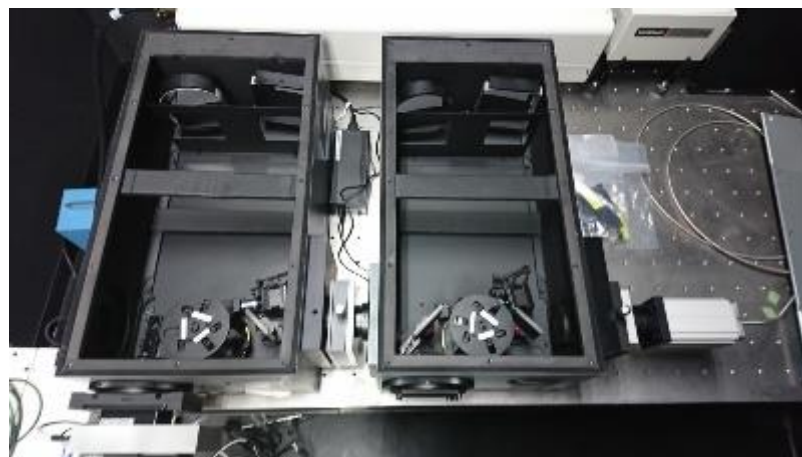
図2 開発した多波長分光検出器の構成（上：構成図、下：写真）
