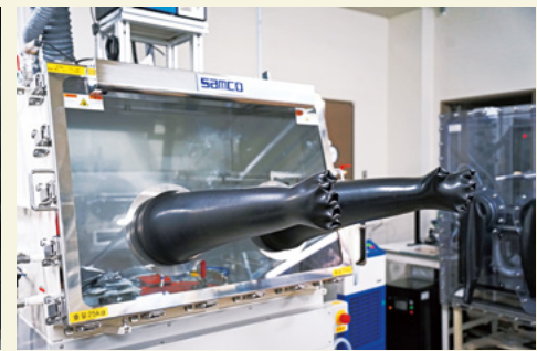
左 / 太陽光を模した光を当てて、ペロブスカイト太陽電池の発電効率を調査 右 / 酸素や水に不安定な化合物の実験に欠かせないグローブボックス。外気に一切触れずに作業ができる
