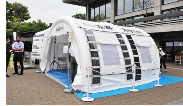
災害用テントにペロブスカイト太陽電池を設置。実証実験に成功
