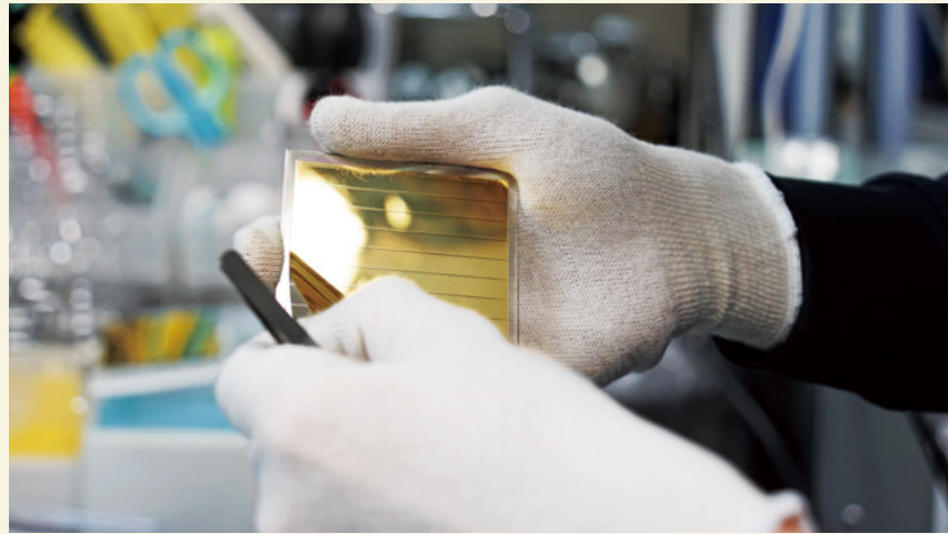
左 / 太陽光を模した光を当てて、ペロブスカイト太陽電池の発電効率を調査 右 / 酸素や水に不安定な化合物の実験に欠かせないグローブボックス。外気に一切触れずに作業ができる
