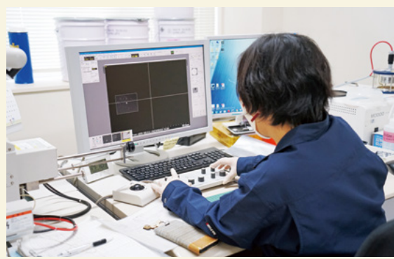
できあがったペロブスカイト層は顕微鏡で確認し、表面のなめらかさをチェック
