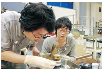
▲課題研究における実験。放射光を利用した流体金属のコンプトン散乱実験で、試料の加熱機構を院生がセットしている様子。
