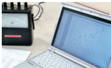
電圧V ACC を上げると、マイクロアンペア計に流れる電流量は増加するが、電圧がある値になると電流は急激に減少する。さらに電圧を上げると電流はふたたび増加しはじめるが、ある電圧に達すると、電流はまた激減する
