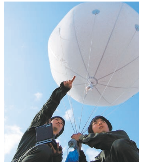
大気の接地境界層の観測 都市のヒートアイランド現象のメカニズムを解明するために行なう、バルーンによる大気の鉛直温度分布連続観測
